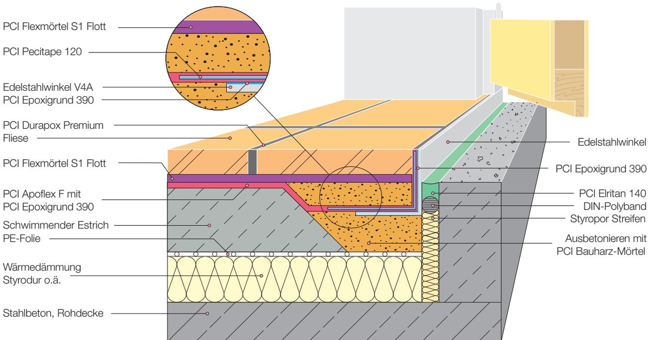
**Detail: Fußbodenaufbau mit Wandanschluss**
